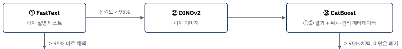
그림 2. 운영한 하자 분류 모델의 3단 구조. 세 모델이 서로 다른 자원(CPU·GPU)을 쓰기 때문에 서빙과 재학습 인프라를 단계별로 나눠야 했다.
